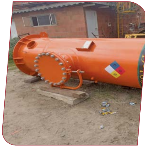
Tanques para aire comprimido
